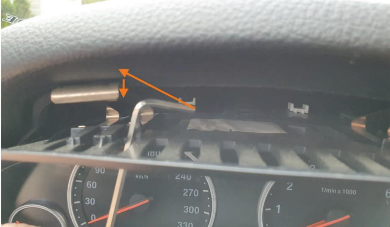
Am Kombiinstrument den Stecker lösen. Dabei die Nase am Stecker drücken:
