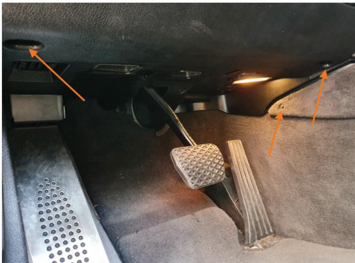
Die Leiste Richtung Mittelkonsole hervorziehen um die Fußraumabdeckung herunter zu klappen.
