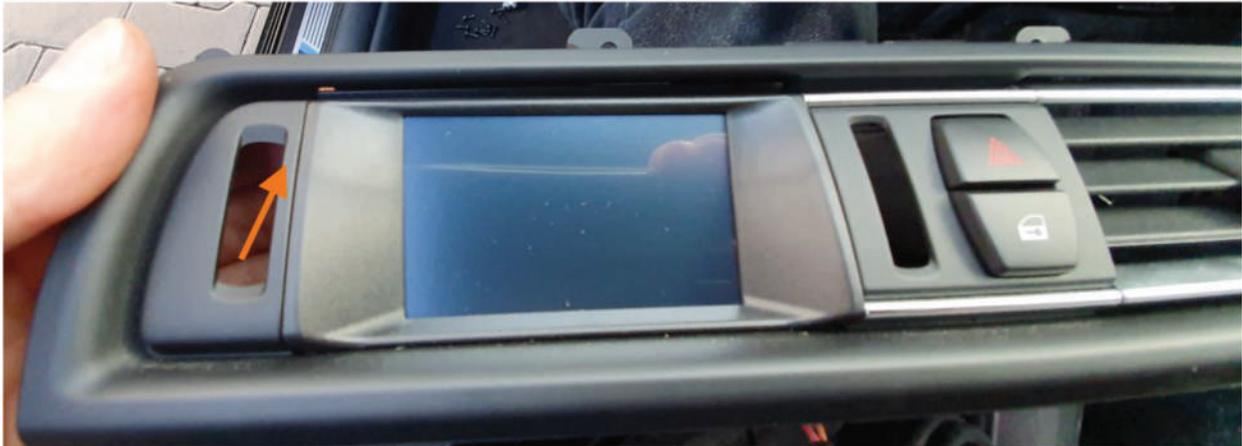
Den vorher entfernten Bügel wieder aufschieben und mit Kleber fixieren oder „verschweißen“ mit z.B. einem alten Lötbolben oder einem heißem Schraubenzieher:
