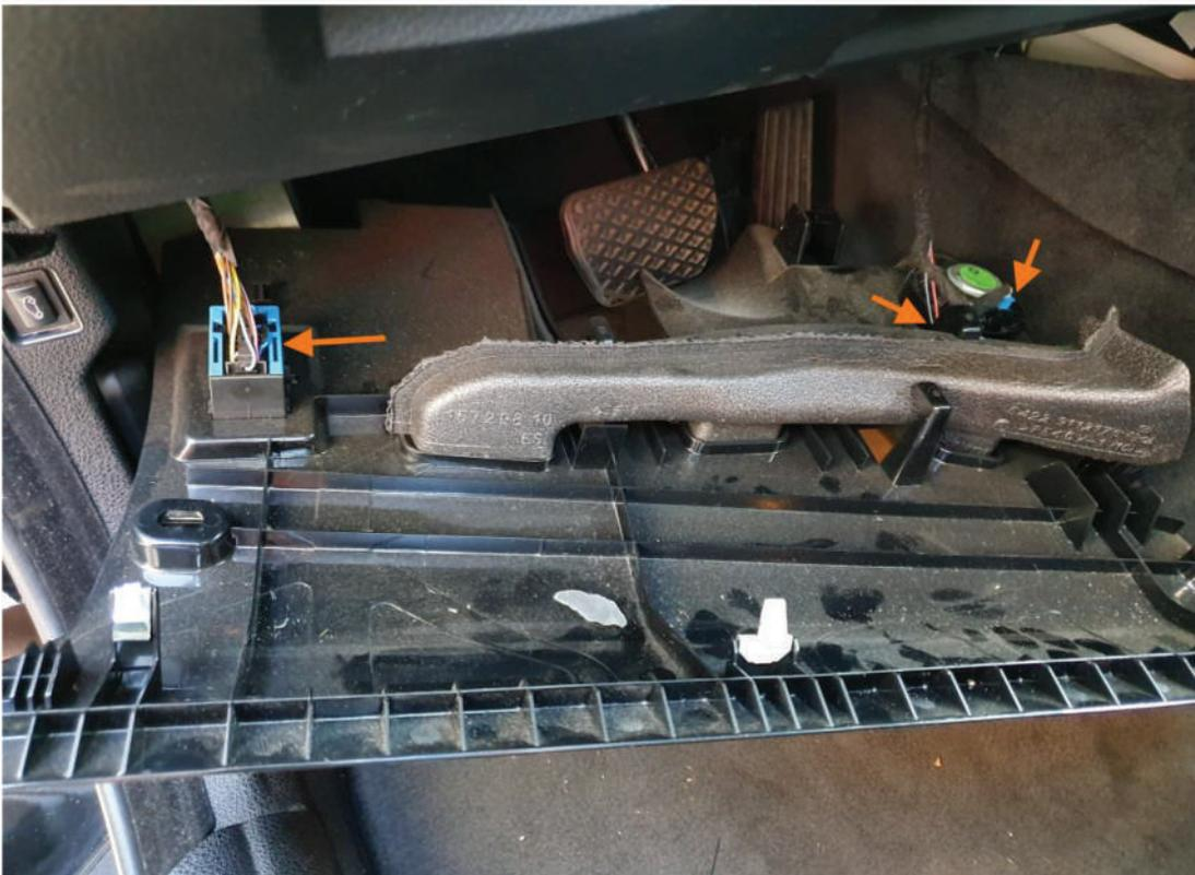
OBD2 Dose, den Bügel in Richtung Motorraum schieben und den Stecker entnehmen:
