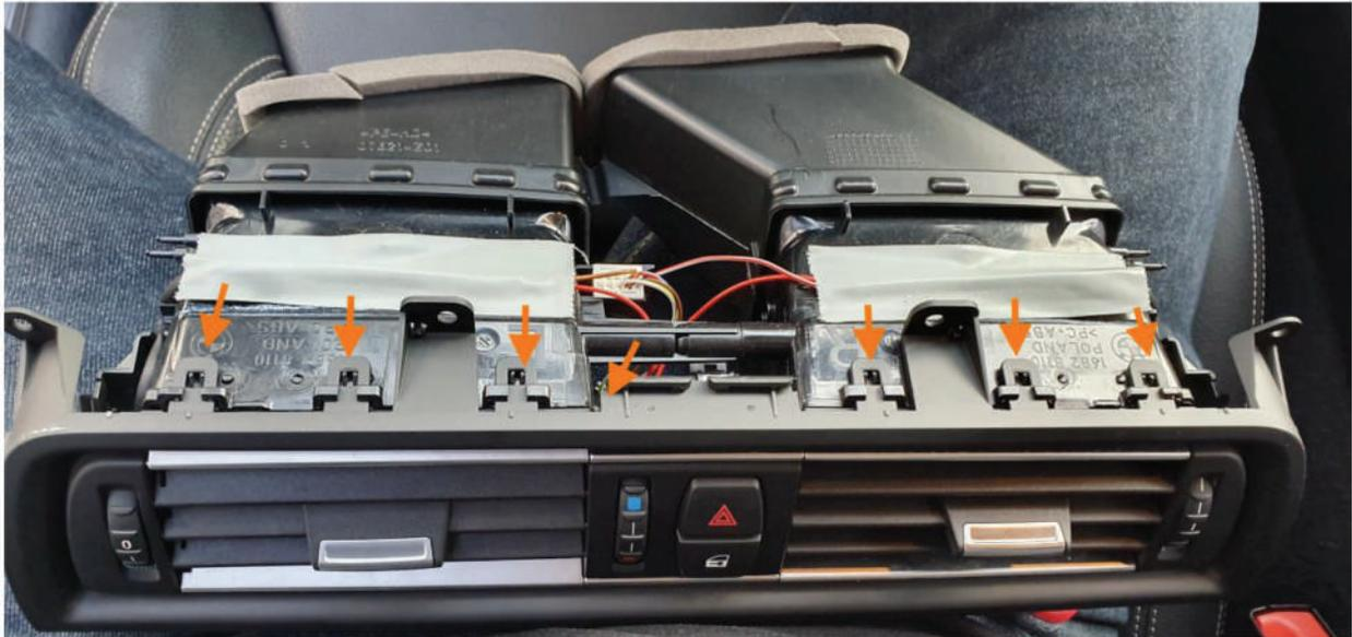
An der Blende ist ein Bügel „verschweiß“ der verhindert das die Lamellen herausfallen. Den Bügel mit einem Flachsraubendreher heraus hebeln und die Lamellen entfernen:
