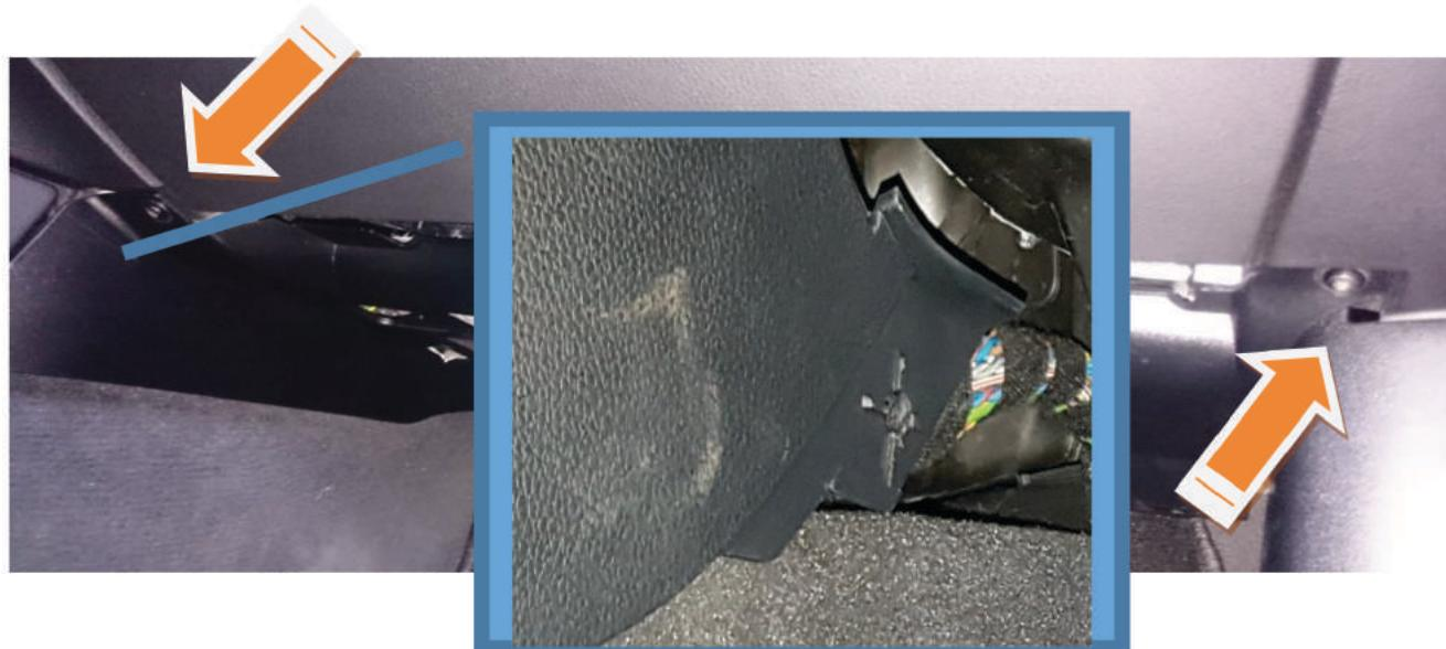
Die Abdeckung kann jetzt vorsichtig abgelassen werden. Achtung, es ist noch eine Steckverbindung der Fußraumleuchte zu trennen.
